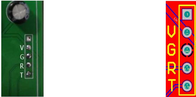
使用 USB 转 TTL 接口连接，接线方式如图，
