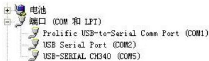
如果在设备管理器中没有发现 COM 口, 则意味您没有安装 USB 转 485 驱动 (资料包中有) 或者没有正确安装驱动, 请联系技术人员取得帮助。
