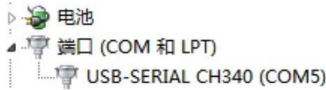
②、单独只接一台设备并上电，使用485串口调试相关工具测试，端口号与电脑COM端口号一致，默认波特率为9600bit/s，默认地址为0x0002.
