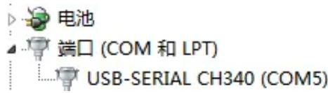
②、单独只接一台设备并上电，使用485串口调试相关工具测试，端口号与电脑COM端口号一致，默认波特率为9600bit/s，默认地址为0x0002。
